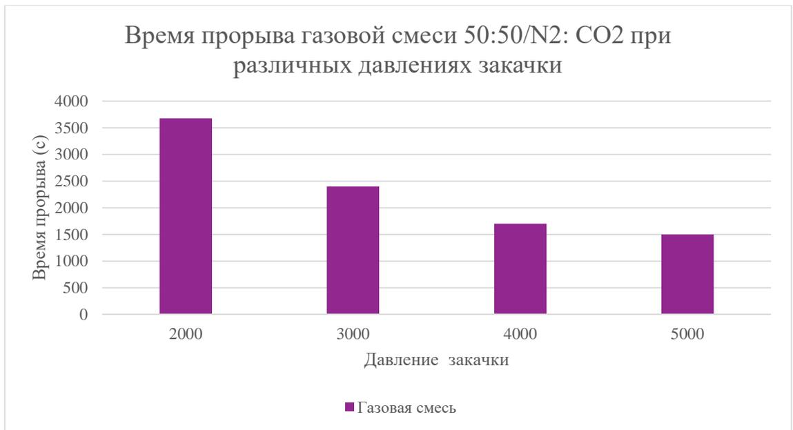
Рисунок 11- Время прорыва газовой смеси 50:50/N<sub>2</sub>: CO<sub>2</sub> при различных давлениях впрыска
