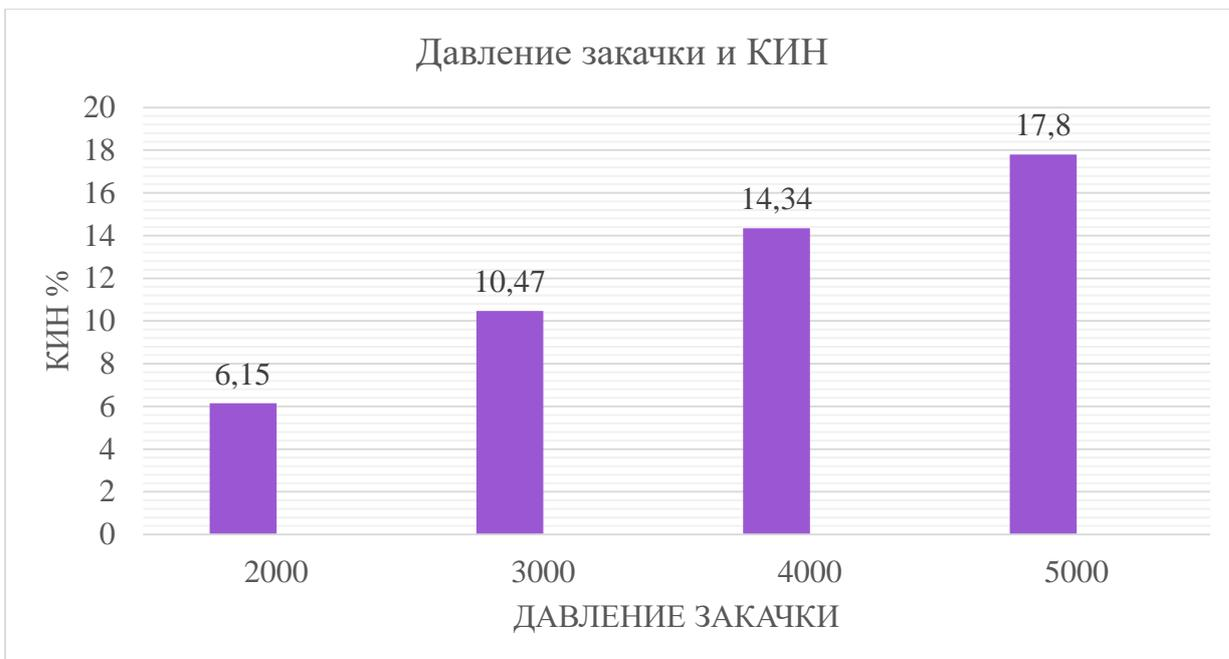
Рисунок 9- Коэффициент извлечения нефти при различных давлениях закачки для газовой смеси 50:50/N2: CO2
